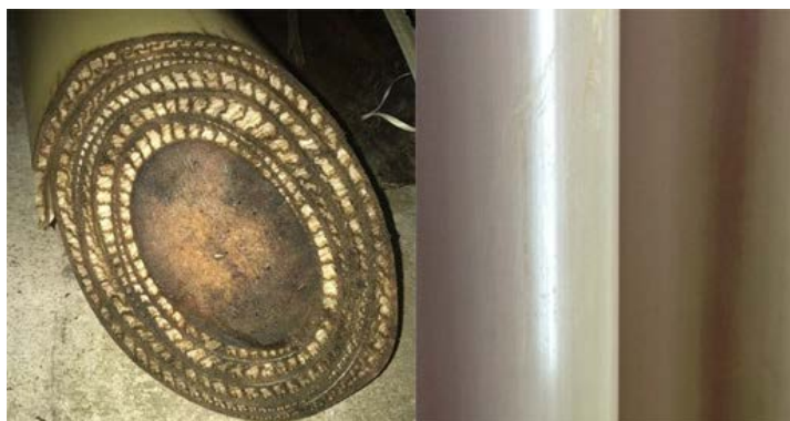
Figura 1 Corte transversal do caule: interior e exterior da fibra de bananeira
