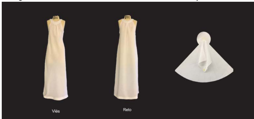
Figura 4: Produtos feitos na viscose em diferentes fios e medição de caimento.
