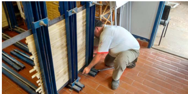
Figura 3: Utilização de prensa para a colagem das lâminas de bambu
