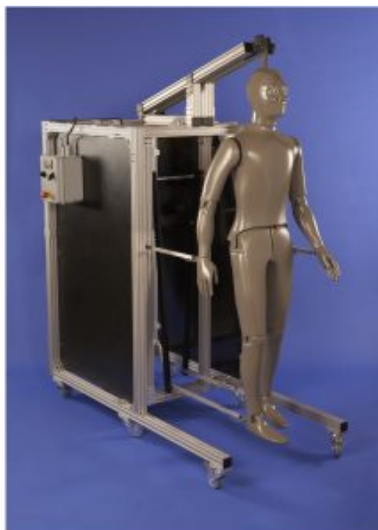
Figura 01: Manequim térmico com simulação de movimentos. Fonte: TexControl, 2016.
