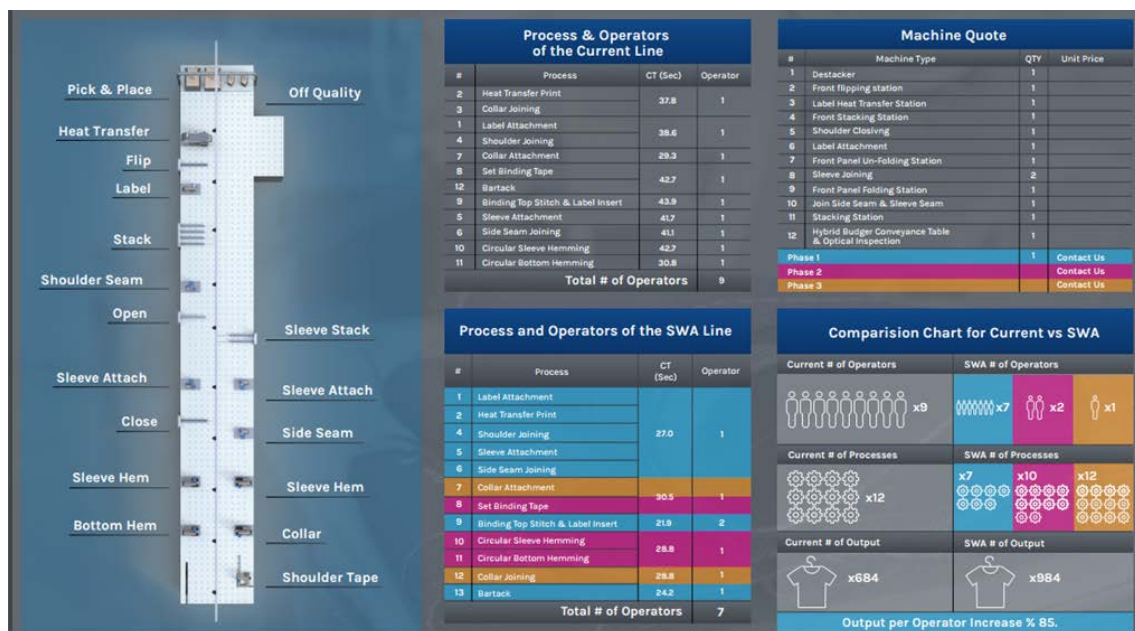
Figura 4 - Esquema de produção e parâmetros de eficiência da solução em fase final de desenvolvimento e testes proposta pela Software Automation para uma linha de produção de camisetas básicas.
