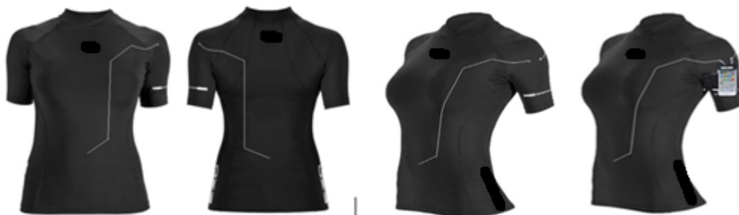
Figura 4 – Simulação do protótipo da peça de vestuário com os eléttodos. Fonte: DX3 Camiseta Feminina / Adaptação do circuito pelo próprio autor
