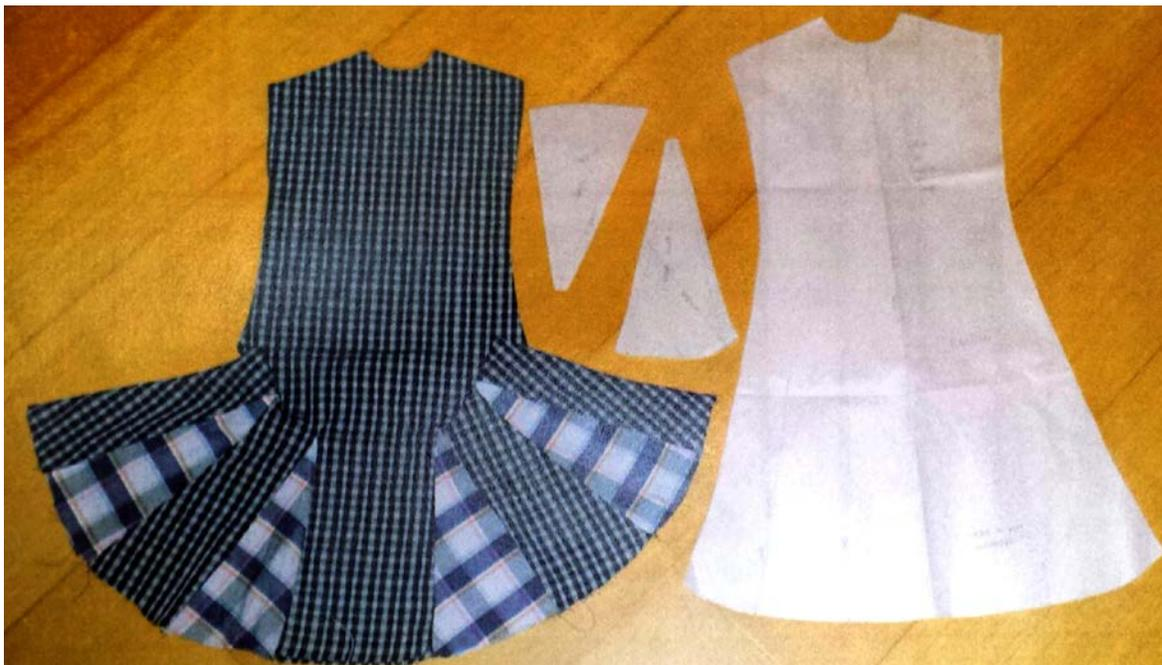
Como último experimento procurou-se reproduzir o *shape* do vestido jeans fazendo uso do material têxtil mais maleável, a viscose. Buscou-se uma forma de não alterar a superfície têxtil mas sim a modelagem, somente ampliando a curva da barra em três vezes o seu tamanho inicial. Apesar da fluidez, o excesso de tecido se acumulou nas laterais conferindo o mesmo formato do vestido jeans, como se pode verificar na Figura 4.
