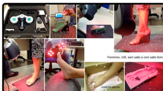
figura 2 - captura digital do modelo de pé feminino número 36 descalço e na posição com salto de 9cm
