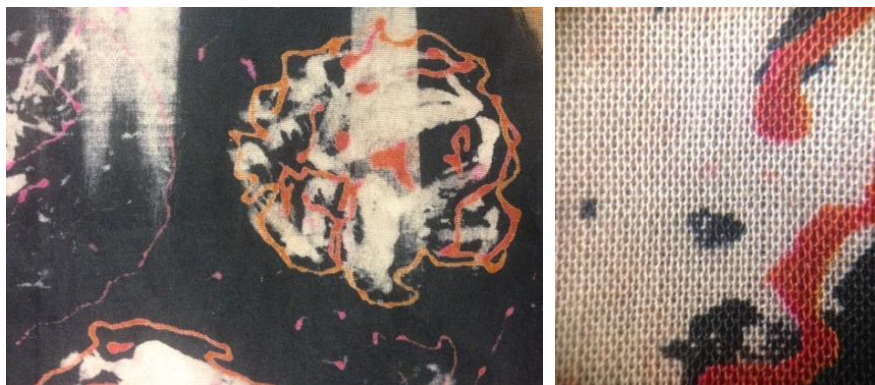
Figura 3a: Estamparia por corrosão à cor; Figura 3b: Detalhe de estamparia por corrosão à cor com adição de corante em tons de vermelho (Acervo pessoal).
